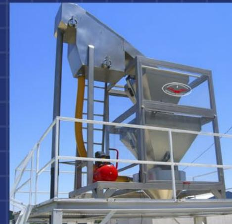
PESADORA CONTÍNUA CON SEPARADOR DE SALMUERA ESPECÍFICA PARA EL LLENADO DE CISTERNAS EVITANDO QUE LA ACEITUNA QUEDE SIN LÍQUIDO DURANTE EL PROCESO
